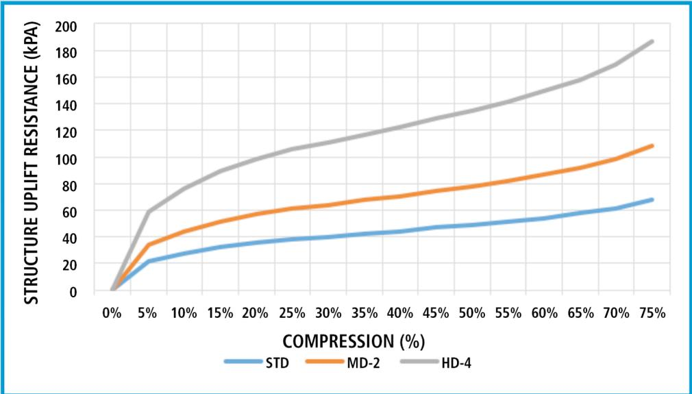
**DYNAFLEX LONG TERM UPWARD PRESSURE AT VARIOUS RATES OF COMPRESSION (kPa)**
